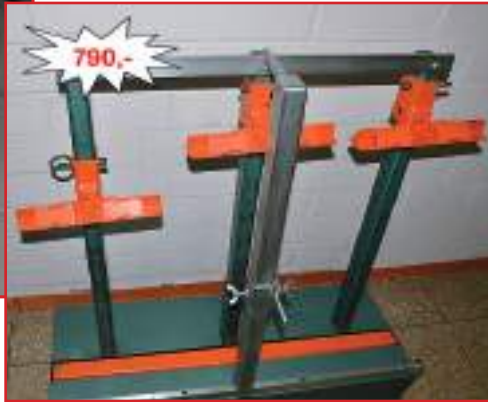
BECK Verleimständer, 3 Niederhalter, Spannmaße: 720 mm, Stellmaß: 400x1.050x 1.100mm, guter Zustand
