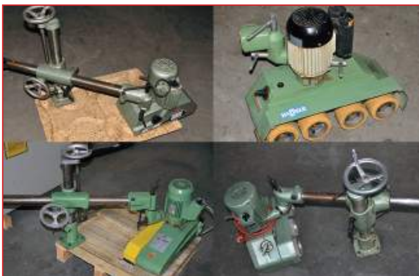
WEGOMA VS 18/180 mit Stativ, Neugerät, CE-Zeichen, für Formteil-Kantenanleimmaschinen, Einsatzzweck runde Teile, ovale Tischplatten, Stuhlsitze, bogenförmige Teile, etc., kraftvoller Durchzug, 1 Rolle \varnothing=180\text{mm} , Motor 0,73kW, 380Volt, Geschwindigkeitsregelung 0,9-20m/min über 8 Stufen,
