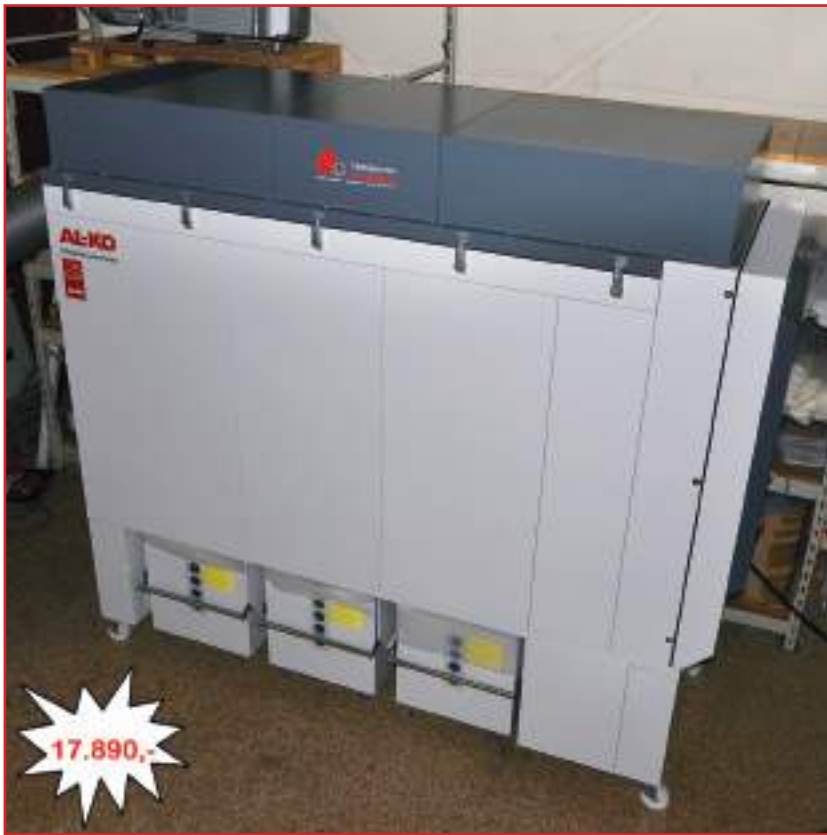
AL-KO Mobil Power Unit APU 300 P FU Silent, Neumaschine, CE-Zeichen, schallgedämpft 65dB, mit Kulissenschalldämpfer (größere Höhe beachten), Ansaugstutzen \varnothing = 300\text{mm} , drehzahlgesteuerter Motor 400Volt - 7,5kW mit Inverter, Vorabscheidung zur Filterschonung, 3 fahrbare Abscheidecontainer je 250ltr. mit Staubschott, pneumatisch gesteuerte Filterabreinigung (über SPS), Abmessungen: L= 3.000mm, B= 1.058 mm, H= 2.898mm, Gewicht ~ 958 g, max. Volumenstrom 6.000m 3 /h, max. Unterdruck 3.640Pa, Maschine pulverbeschichtet, Listenpreis inkl. Vorracht 19.250,- Euro, Bild links oben
