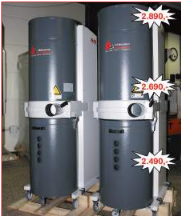
AL-KO Mobil Power Unit APU 100, Neumaschine, CE-Zeichen, Motorleistung 1,5kW (400Volt Drehstrom), Gewicht 116kg, max. Unterdruck 2.124Pa, weitere Daten wie 230Volt Ausführung
