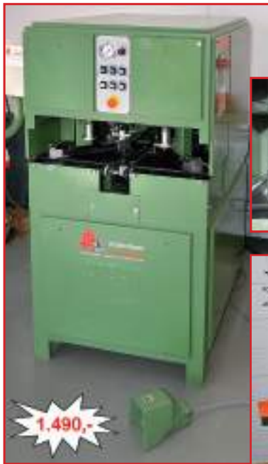
BECK Verleimständer, 3 Niederhalter, Spannmaße: 720 mm, Stellmaß: 400x1.050x 1.100mm, guter Zustand
