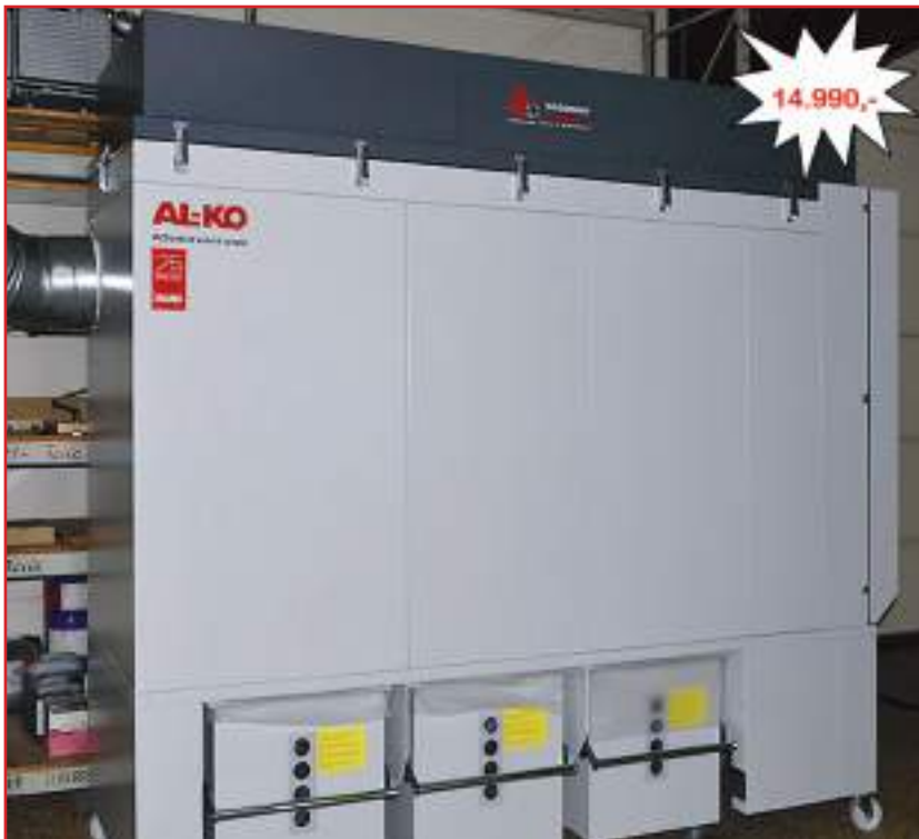
AL-KO Mobil Power Unit APU 300 P Silent, mit Spezialschalldämpfer, Neumaschine, schallgedämpft 65dB, Motor 400Volt - 7,5kW mit Kulissenschalldämpfer (größere Höhe), Ansaugstutzen \varnothing = 300\text{mm} , Vorabscheidung zur Filterschonung, pneumatisch gesteuerte Filterabreinigung (über SPS), 3 fahrbare Abscheidecontainer je 250 ltr. mit Staubschott, Abmessungen: L= 3.000 mm, B= 1.058 mm, H= 2.898 mm, Gewicht 888kg, max. Volumenstrom 6.000m 3 /h, max. Unterdruck 3.434Pa, Maschine pulverbeschichtet, Listenpreis inkl. Vorracht 16.850,- Euro, Bild links
