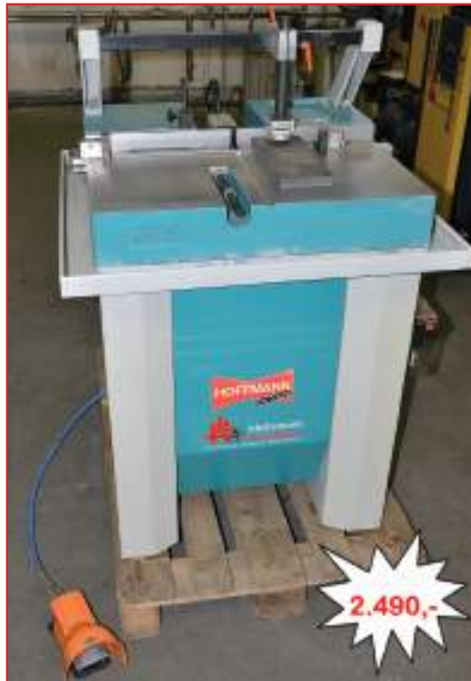
HOFFMANN Schwalbenschwanzfräse X.Line20 Neumaschine, CE-Zeichen, manuelle Tischausführung, 230V 0,5kW, Durchgangshöhe 110mm, Frästiefe 0-80mm, Absaugstutzen Ø=60mm, Schwalbengrößen 1, 2, 3, Gewicht 19kg, Abmessungen 600x540x770mm
