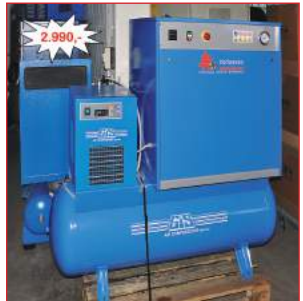
GIS GS 38/850/300/Silent-dry, Neumaschine, CE-Zeichen, schalldämpfter 2 Zylinder Kompressor mit Vollkapselung und Kältetrockner, Elektrolüfter zur Hilfskühlung, Betriebsstundenzähler und Motorschutzschalter, maximaler Volumenstrom ca. 850ltr./min bei 11bar, Motor 5,5kW, besonders leise, nur 68db/A, mit Kältetrockner und 300ltr. Kessel, Steuerpult, Abmessungen 1.520x620x1.530mm, Listenpreis rund 4.350,-, Bild oben
