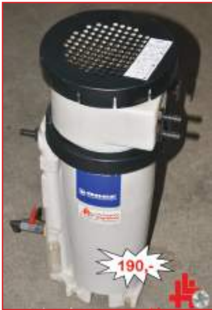
Öl Wasser Trenngerät, mit Aktivkohlefilter, Platzbedarf LxBxH 600x380x950mm, guter Zustand
